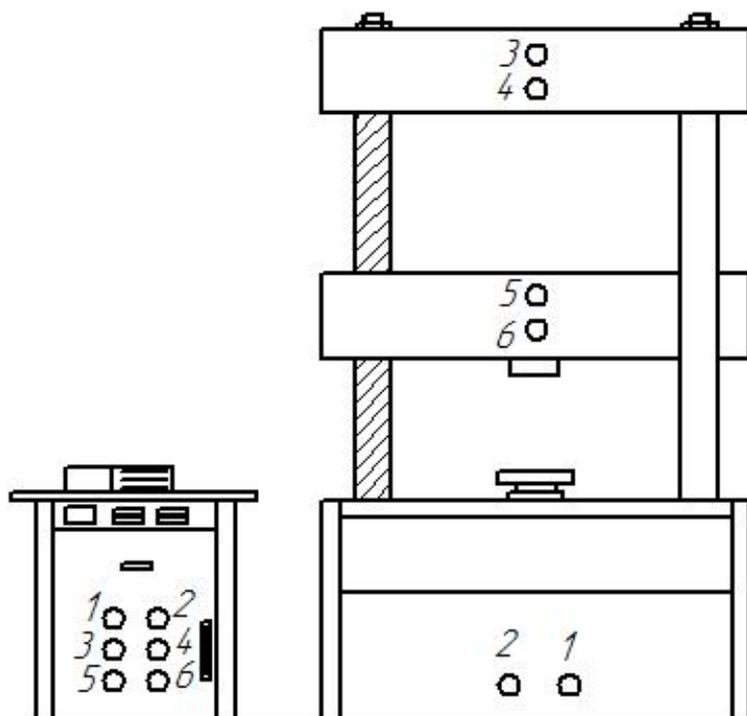
Рисунок 7 – Схема подключения РВД.
