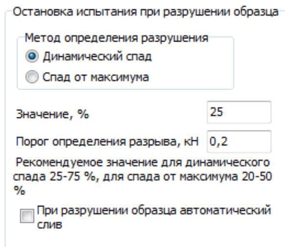
Рисунок 11.8 Настройка определения разрыва на РГМ
