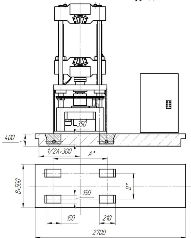
Рисунок 6 - Независимый фундамент и установочные размеры.
