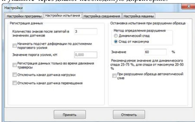
Рисунок 13.13 Настройки испытания PGM
