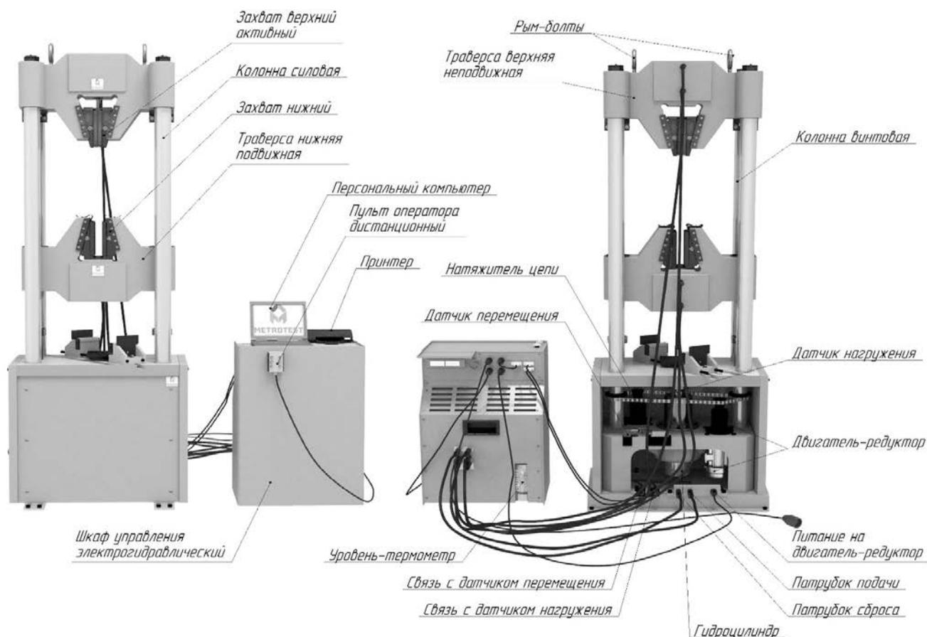
Рисунок 1 - Схема устройства машины РГМ-А (общий вид)
