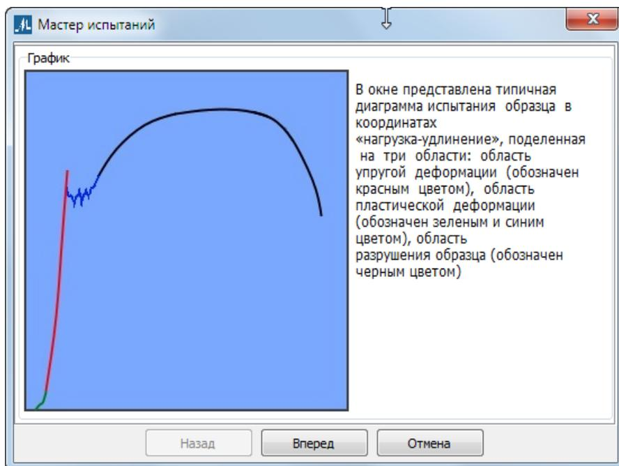
Испытания по ГОСТ 1497 состоят из 3 этапов. Диаграмма испытания в координатах «нагрузка – удлинение» состоит из 3 областей.
