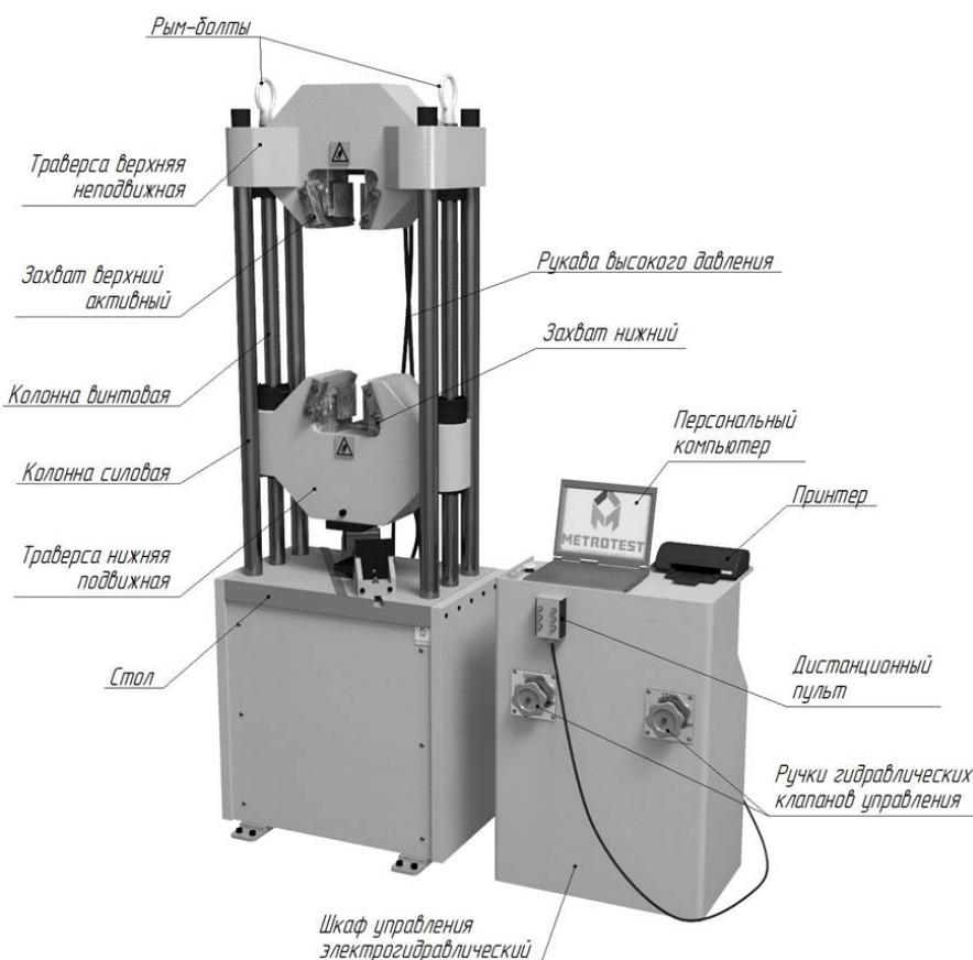
Рисунок 1 - Схема устройства машины РГМ-М (общий вид)
