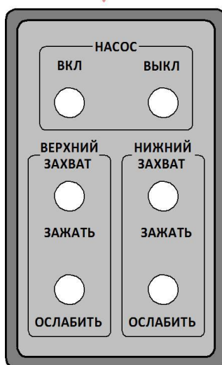
Пульт управления гидравлическими захватами
