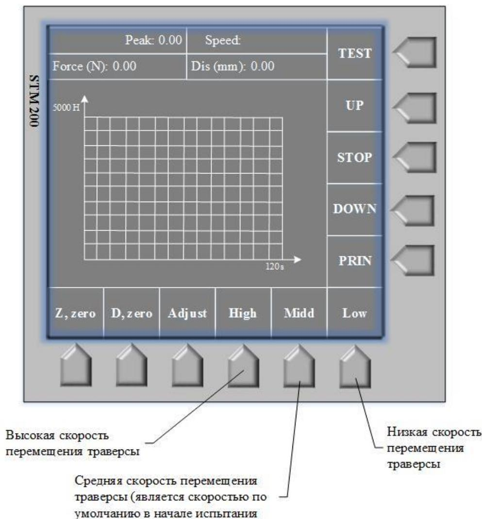
Рисунок - Изображение на дисплее ПУ «STM 200 во время испытаний
