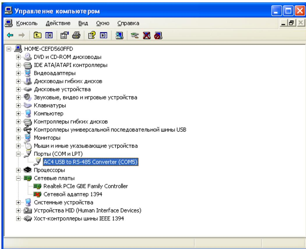
Цветом выделен СОМ порт, к которому подключена система измерения
