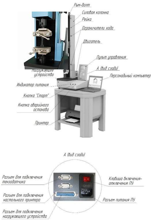
Конструктивно машина испытательная универсальная РЭМ-М состоит из силозадающего модуля, системы измерения и управления с пультом оператора STM200 и персональным компьютером с установленным программным обеспечением «M-Test» (**Ошибка! Источник ссылки не найден.**).
