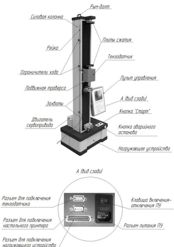
Датчик перемещения измеряет перемещение подвижной траверсы по всей длине силовой колонны.
