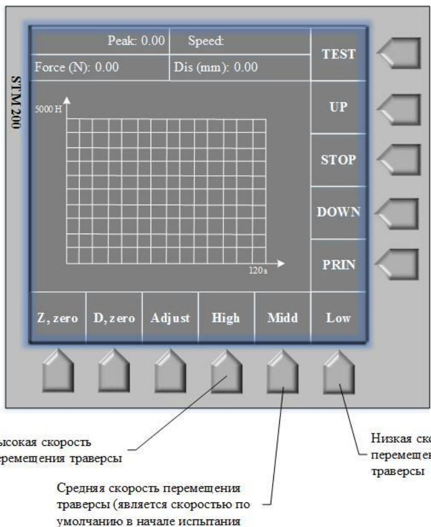
Рисунок - Изображение на дисплее ПУ «STM 200» во время испытаний
