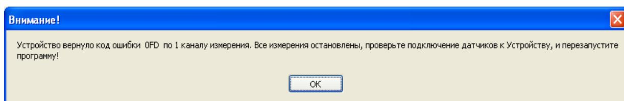
Ошибка, возникающая при обрыве датчика измерения или подключении неверного канала измерения
