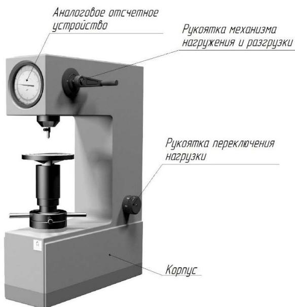
Твердомер модификации «ИТР-М» позволяют измерять твердость мелких деталей, деталей с упрочненными поверхностными слоями, алюминиевых сплавов, тонких плит и других материалов. Твердомеры обеспечивают испытания в диапазоне нагрузок от 15 кгс до 45 кгс.
