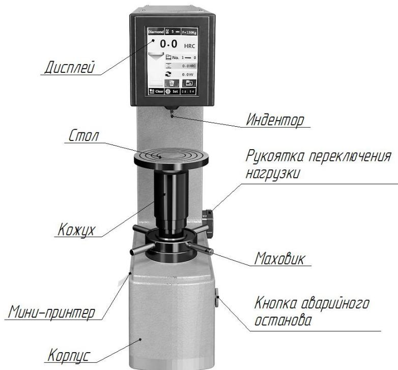
Конструктивно твердомер состоит из механизмов нагрузки и разгрузки, подъема рабочего стола, микропроцессорного блока.
