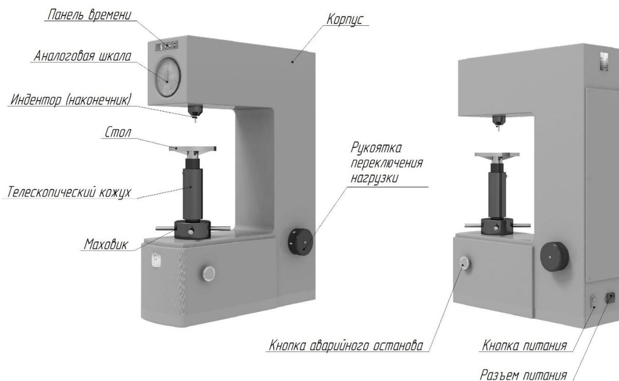
Конструктивно твердомер состоит из механизмов нагрузки и разгрузки, подъема рабочего стола, аналоговой измерительной системы.
