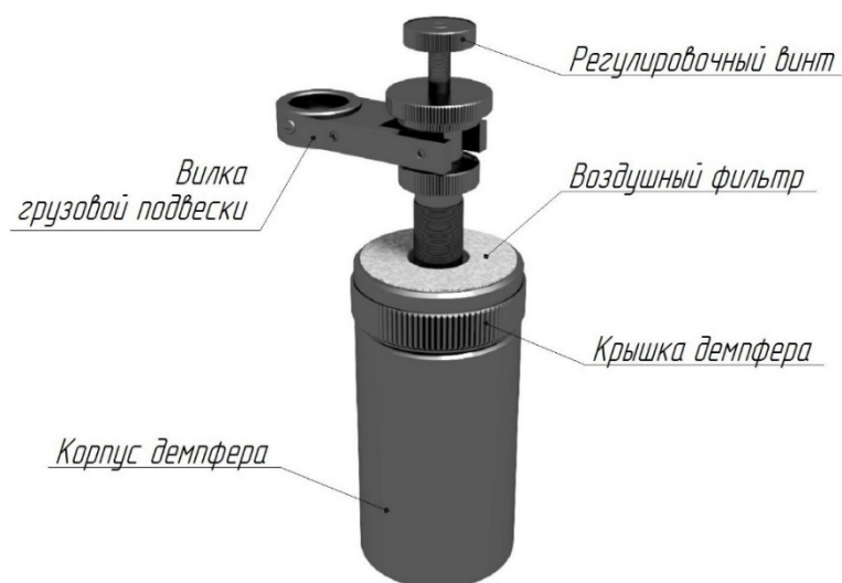
Рисунок 6 – Демпфер грузовой подвески
